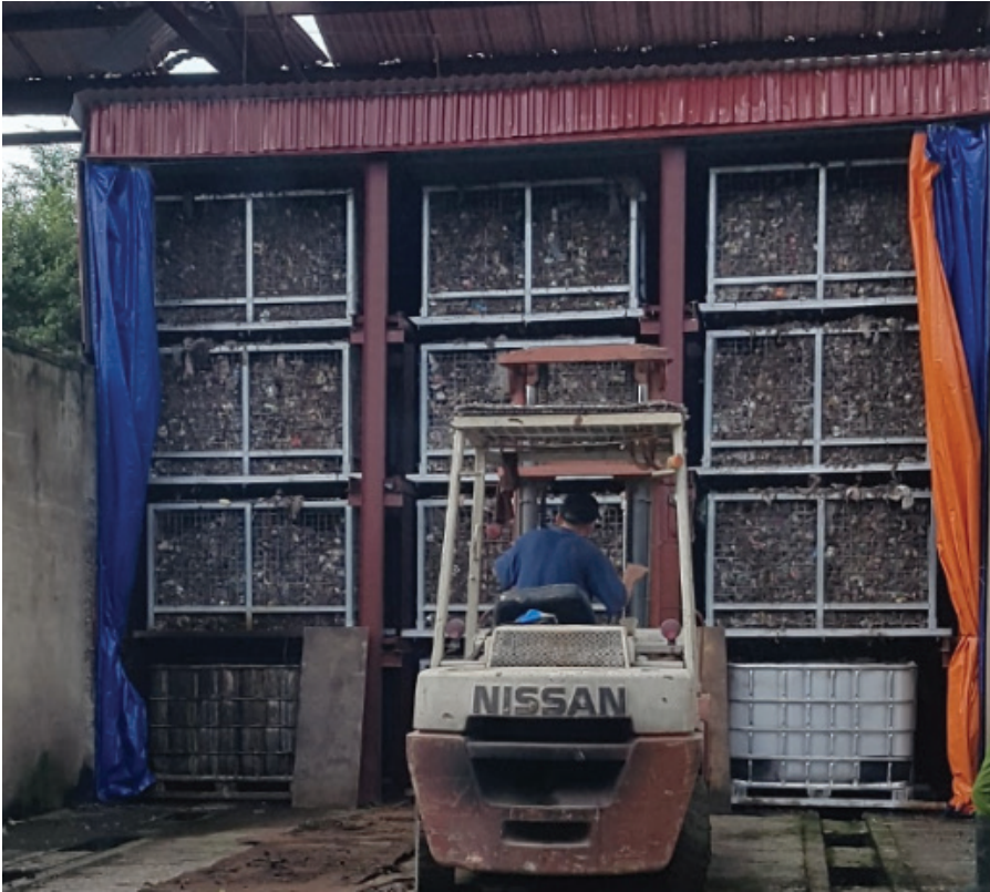
Các bồn chứa rác được xếp chồng thành từng tầng giúp tiết kiệm diện tích, dễ phân hủy nhờ không khí len lỏi qua từng lớp rác một cách dễ dàng.
