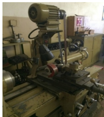
Hình 1. Hình ảnh máy gia công hót lưng 15811
