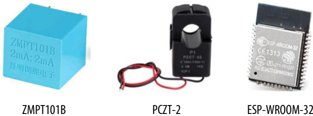
Hình 3. Các linh kiện thực hiện nguyên lý đo điện áp và dòng điện
