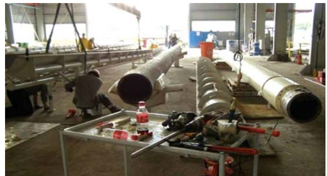
Ảnh 2. Sản phẩm ống trần và sau khi bọc lớp PU Foam cách nhiệt
