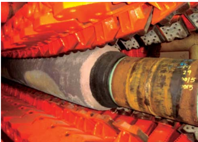
Ảnh 7. Sản phẩm được thử nghiệm kẹp ống trong quá trình rải ống tại Mc Dermott, Indonesia
