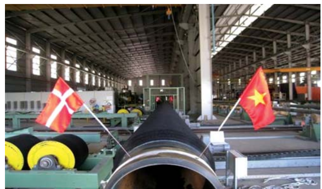
Ảnh 4. Sau các quá trình bọc chống ăn mòn và cách nhiệt, sản phẩm được bọc bê tông gia trọng
