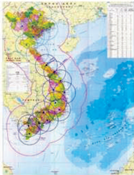
Hình 2. Phạm vi phát hiện sét của các cảm biến dòng sét của hệ thống quan trắc – giám sát – cảnh báo dòng sét (Đường màu tím: phạm vi phát hiện hiệu dụng)
