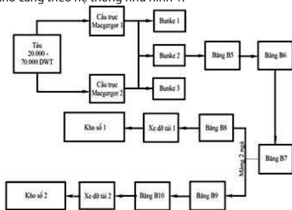
Hình 1. Sơ đồ công nghệ sản xuất hệ thống nhập than
