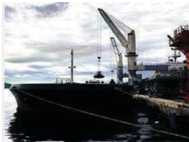
Hình 2. Cầu trục chân đế Macgregor GL 4036-2
