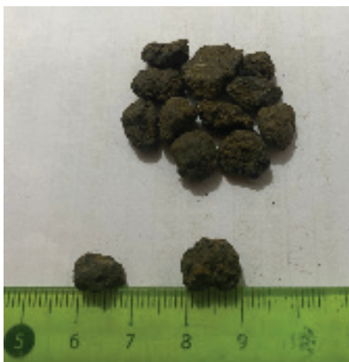
Hình 7. Các nodule Fe-Mn hình cầu chứa Ni, Co.
