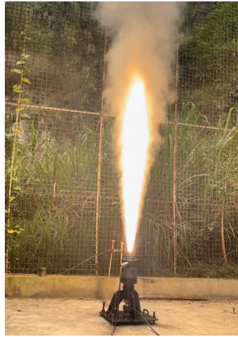
(B) Hình ảnh đốt thử nghiệm động cơ mẫu.
