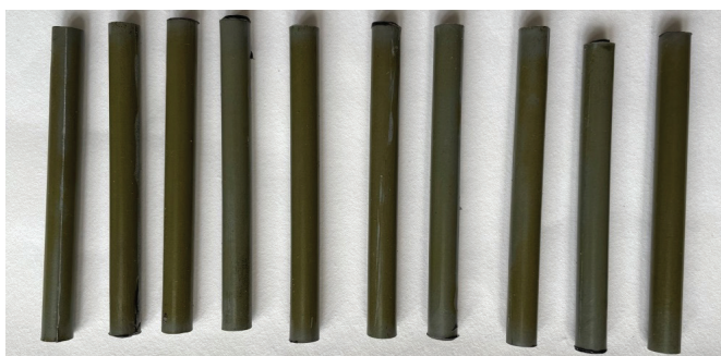
Hình 1. Mẫu thử nhiên liệu sau hóa rắn phục vụ kiểm tra tốc độ cháy.
