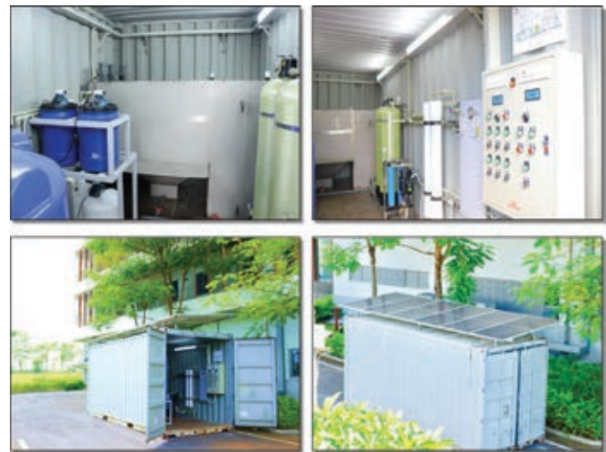
Hệ thống tích hợp xử lý nước nhiễm mặn, nhiễm phèn của VKIST.
