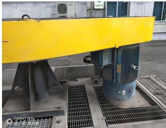
Hình 13. Động cơ LSPMSM của thiết bị hỗ trợ băng tải tuyến nổi mỏ kẽm chì Changba, Tập đoàn Baiyin Nonferrous Metals - Trung Quốc (2015)
