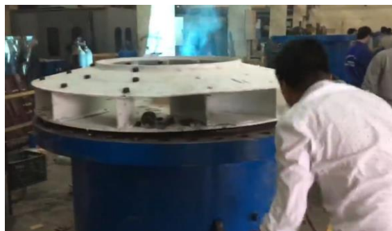
Hình 7. Cánh quạt hút khí flo sau khi phun plasma SiC-50Cu và thẩm thấu PTFE
