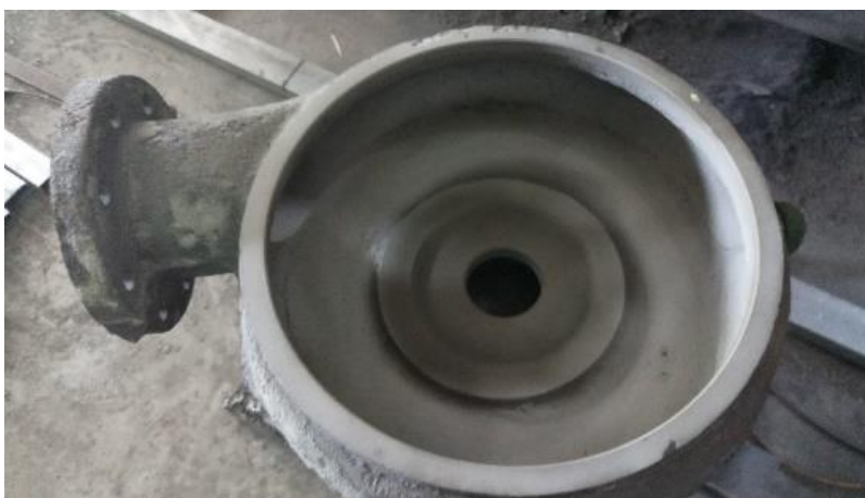
Hình 6. Bồng bơm sau khi phun plasma SiC-50Cu
