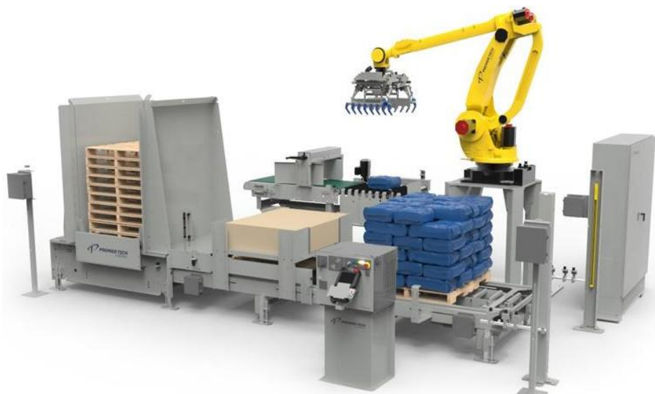
Hình 1. Hình ảnh một hệ Robot bốc xếp hàng tự động
