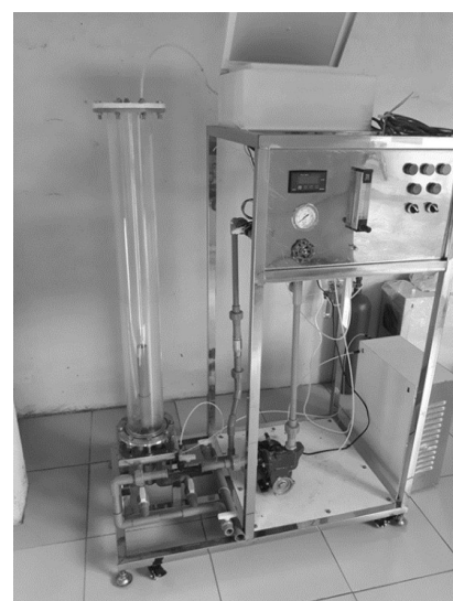
Hình 2. Hình ảnh thực tế của hệ thống tạo ozone bọt mịn để xử lý nước thải bằng ozone bọt mịn.
