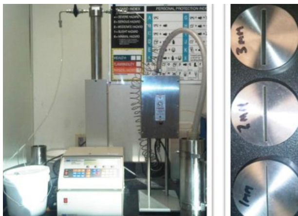
Hình 2: Thiết bị đo và đánh giá khả năng gia cố, ổn định thành giếng khoan do chênh áp suất
