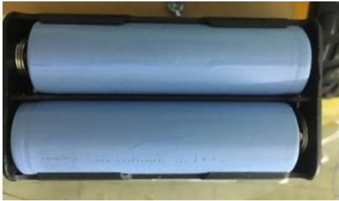
Hình 11. Nguồn dùng pin Cell 18650
