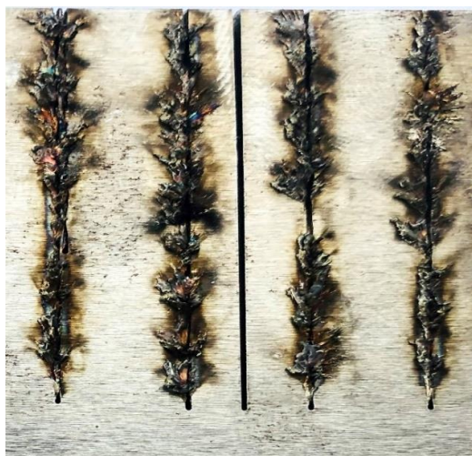
Hình 8. Hình ảnh rãnh cắt dưới có bavia khi sử dụng đường kính đầu cắt d = 5.0 mm
