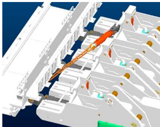
Hình 1. Giàn chống và máng cào được trang bị cơ cấu chống trôi, trượt
