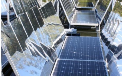
Hình 7. Hệ thống ĐMTN trang bị gương phản xạ [8]
