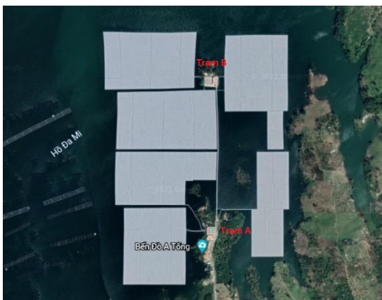
Hình 8. Hình ảnh bố trí mảng pin và trạm inverter tại NM ĐMTN Đa Mi
