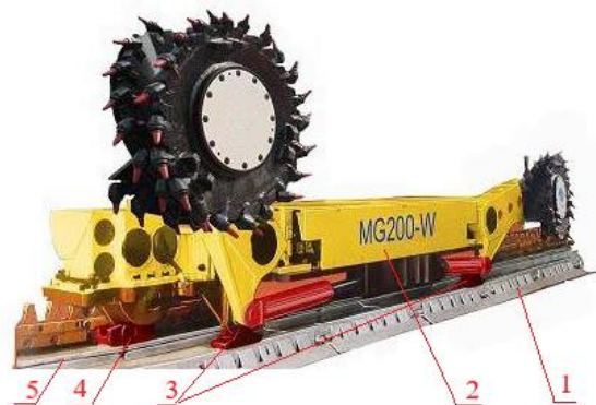
Hình 1. Hệ thống liên hợp máy khâu than-máng cào: 1 – máng cào; 2 – máy khâu; 3 – gối trượt bằng; 4 – gối trượt dẫn hướng; 5 – ghim ray
