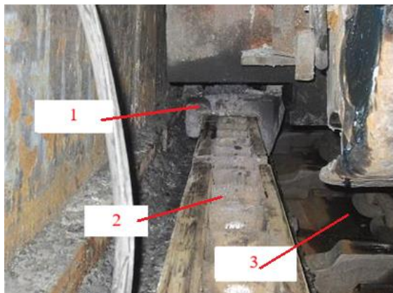
Hình 2. Tương quan vị trí gối trượt dẫn hướng và ghim ray: 1 – gối trượt dẫn hướng; 2 – ghim ray; 3 – máng cào lò chợ
