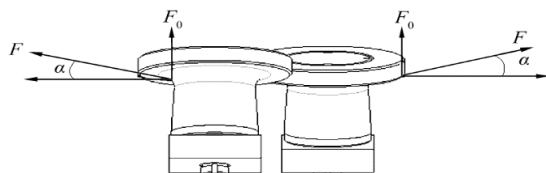
Hình 1. Lực do cáp tác dụng lên con lăn đè cáp
