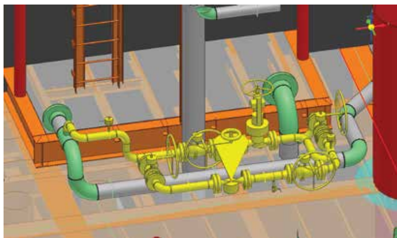
Hình 2. Mô phỏng 3D lắp đặt thiết bị tiết lưu trên RC-5
